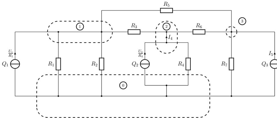
Gegeben sei das oben stehende Netzwerk, mit den zuvor in Stromquellen umgewandelten Spannungsquellen  $Q_1$  und  $Q_2$ . Gesucht ist der Strom  $I_4$ . Welches ist die zugehörige Matrix nach dem Knotenpotentialverfahren? Der Bezugsknoten ist Knoten 0. [4 Punkte]
