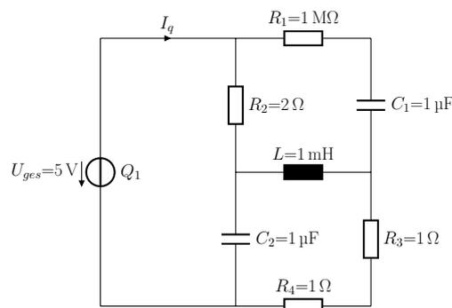
Gegeben sei die oben stehende Schaltung mit der Gleichspannungsquelle  $Q_1$ , welche seit sehr langer Zeit mit dem Netzwerk verbunden ist. Wie groß ist die Spannung über  $R_2$ ? [2 Punkte]
