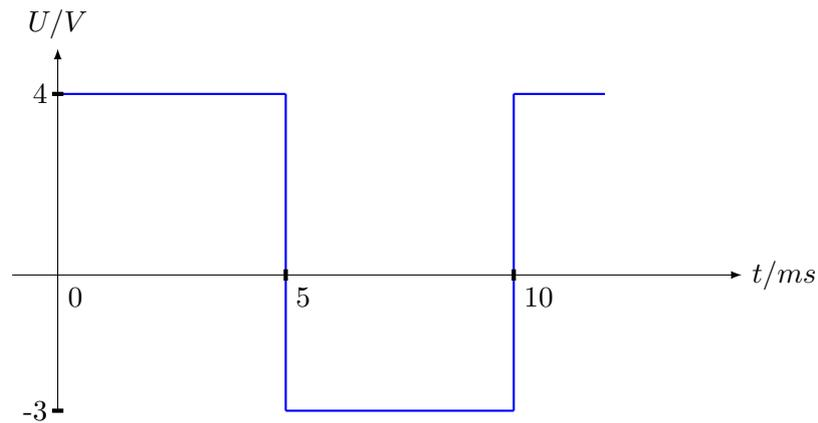
Berechnen Sie den Effektivwert  $U_{eff}$  und den Mittelwert  $\bar{U}$  des obigen Spannungsverlaufs. [2 Punkte]
